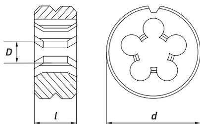
Плашки RODMIX применяются для нарезания наружной резьбы с помощью токарных станков и воротков. Изготавливаются из быстрорежущей стали HSS (M2) и HSSE (M35), аналоги P6M5 и P6M5K5, в соответствии с ГОСТ 9740. Правое и левое направление резьбы, качество точности 6G.
